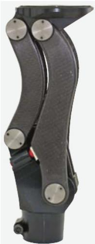
A opção de controle pneumático da fase de balanço neste joelho de barras de carbono, proporciona um controle médio de velocidade combinado com a estabilidade geométrica da fase de apoio para usuários com atividade média a moderada. O perfil baixo da peça proximal é o mais adequado para amputações de desarticulação do joelho.
