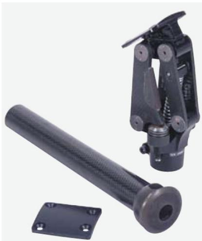
Mecanismo de 4 barras para desarticulação do quadril que proporciona um movimento natural. Permite uma amplitude de 130° de flexão/extensão e uma facilidade no ajuste de alinhamento em todos os planos. Possui diversos graus de ajuste no bloqueio da extensão.
